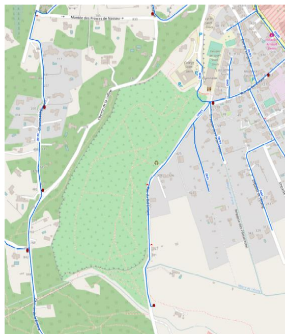
Réseau d'eau potable
