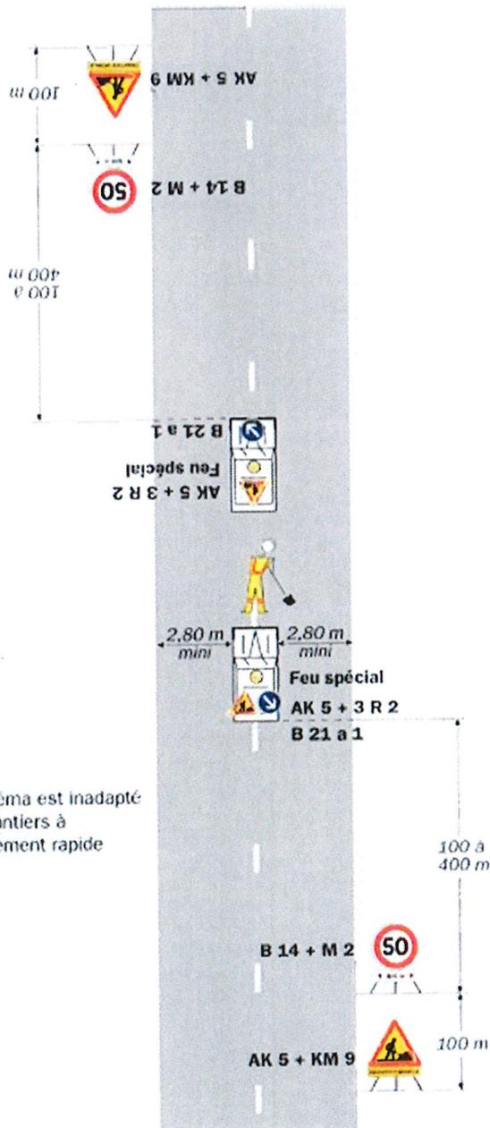
Ce schéma est inadapté aux chantiers à déplacement rapide
