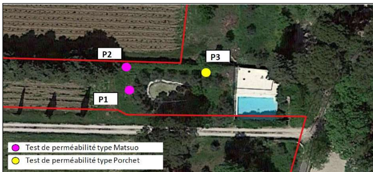
Localisation des tests de perméabilité
