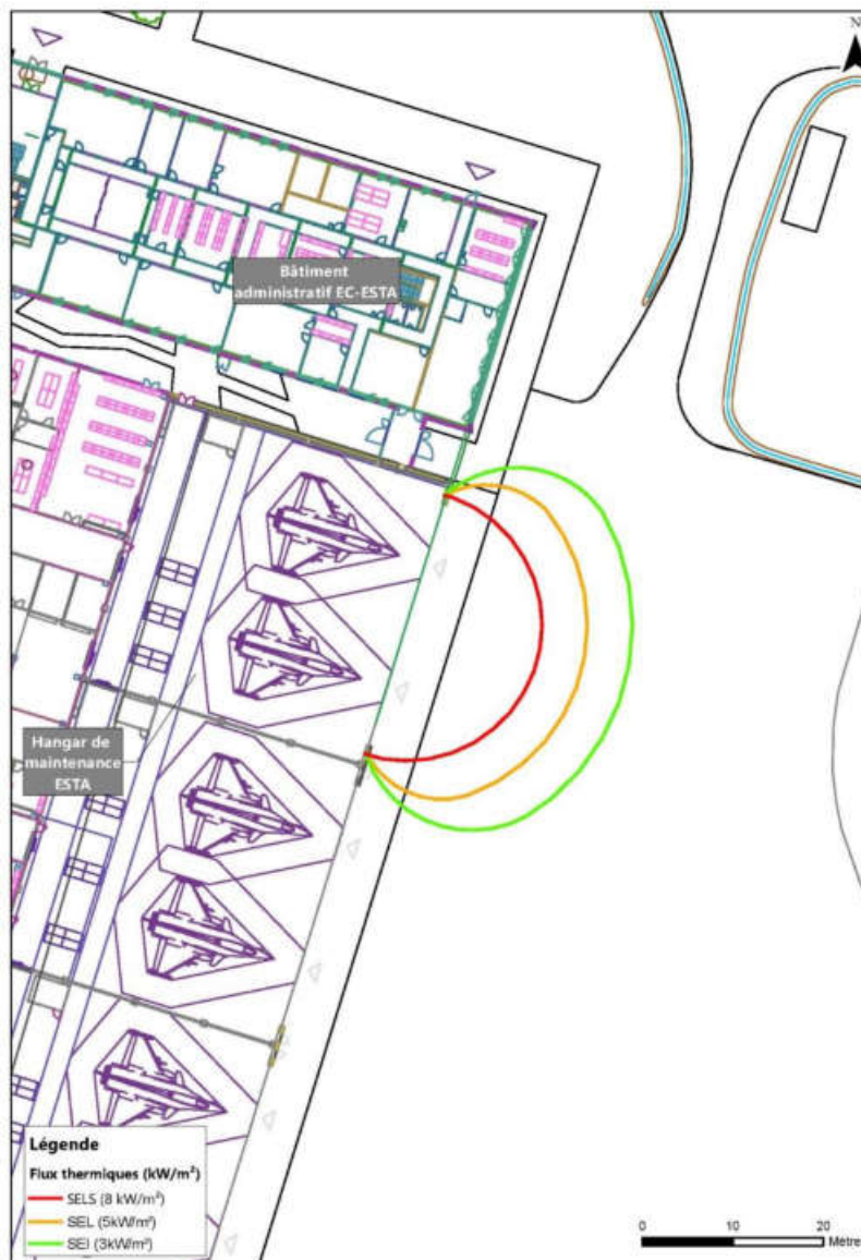
Figure 5 : Cartographie des effets thermiques d'un incendie dans une alvéole située dans le hangar de maintenance ESTA (modélisation Flumilog).
